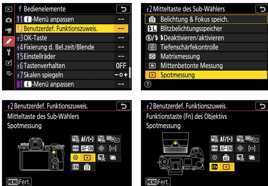
**Abbildung 2.41** Spotmessung auf die Mitteltaste des **Sub-Wählers** oder auf die Funktionstaste (**Fn**) des Objektivs legen
