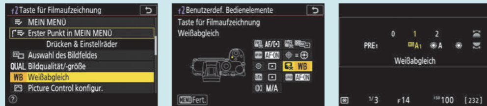
Abbildung 4.18 Den Weißabgleich können Sie für den Fotomodus auf die Videotaste legen. Durch Drücken der Taste und Verdrehen der Einstellräder können Sie ihn dann schnell verändern, ohne über ein Menü gehen zu müssen.
