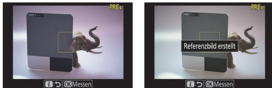
Abbildung 4.22 Innerhalb der gelben Umrandung analysiert die Kamera die benötigten Werte für den manuellen Weißabgleich.
